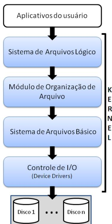
**Figura 2.2:** Estruturação típica de um sistema de arquivos nativo
